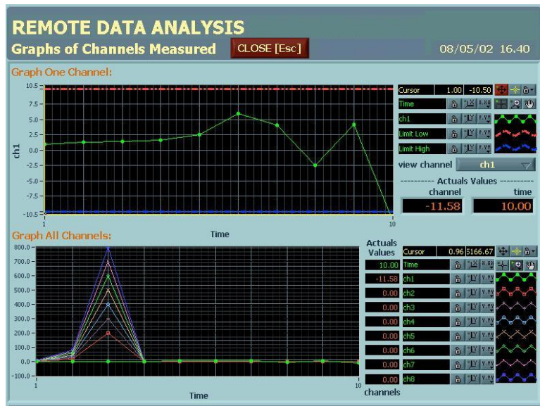
Figura 3: Pannello di visualizzazione dei dati acquisiti dal programma che risiede sul modulo FP-2000.
