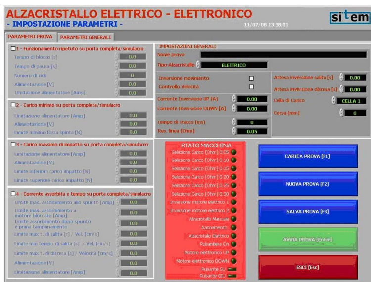
Figura 1: Pannello per la definizione dei parametri di prova di un alzacristallo di tipo elettrico / elettronico
