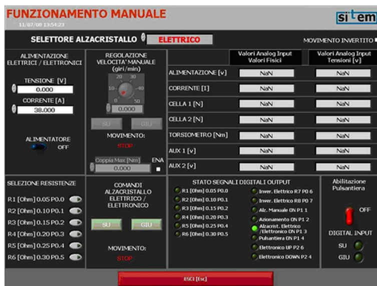
Figura 2: Pannello per la gestione delle prove su un alzacristallo di tipo manuale
