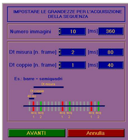
Figura 3: Pannello per l'inserimento dei parametri di acquisizione di una singola immagine.
