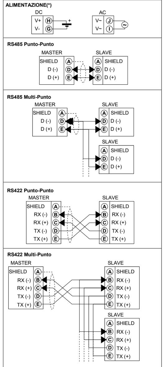
**(\*) : Nota: per installazioni UL il dispositivo deve essere alimentato da una unità di alimentazione con classificazione NEC classe 2 o SELV**
