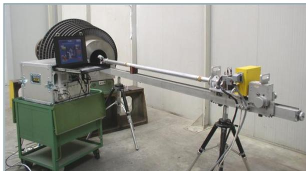
**La soluzione** La soluzione adottata – dal punto di vista dell’acquisizione e controllo - un sistema di acquisizione e generazione dati PXI di National Instruments, ed integra due elettroniche custom per il condizionamento del segnale delle sonde ultrasoniche e per la gestione dei motori di avanzamento delle sonde. Due applicativi realizzati in ambiente LabVIEW consentono la gestione del sistema e l’analisi off-line dei dati acquisiti.
