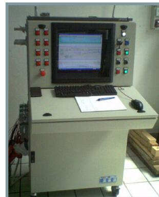
In tutti i casi, la simulazione della condizione "serbatoio vuoto / pieno" avviene tramite immersione controllata dei dispositivi sotto test all'interno di una vasca contenente un liquido con le stesse proprietà di viscosità del carburante. Il sistema software prevede l'utilizzo di un PC equipaggiato con una scheda NI6259 per l'acquisizione dati e di una scheda NI6704 per la generazione delle alimentazioni 4 – 20 mA per i dispositivi pilotati in corrente.
