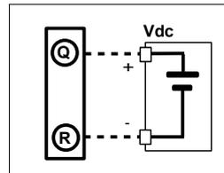
(\*) : Nota: per installazioni UL il dispositivo deve essere alimentato da una unità di alimentazione con classificazione NEC classe 2 o SELV
