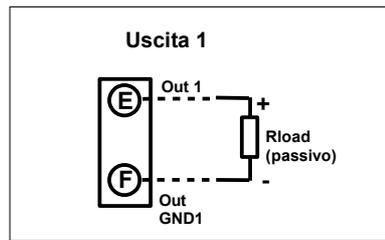
(\*\*) **Nota:** se si verifica una interruzione di collegamento sul loop di ingresso oppure sul loop di uscita, il segnale di uscita è 0 mA.
