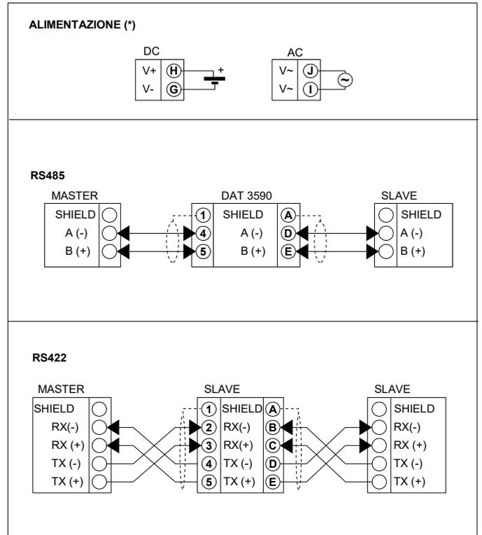
(\*) : Nota: per installazioni UL il dispositivo deve essere alimentato da una unità di alimentazione con classificazione NEC classe 2 o SELV
